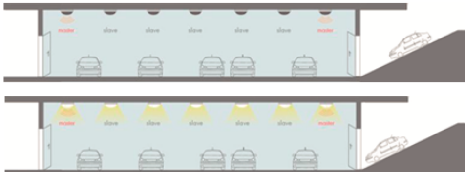
Millora d'usos i costums en il·luminació sensoritzant el pàrquing amb sistemes RF
