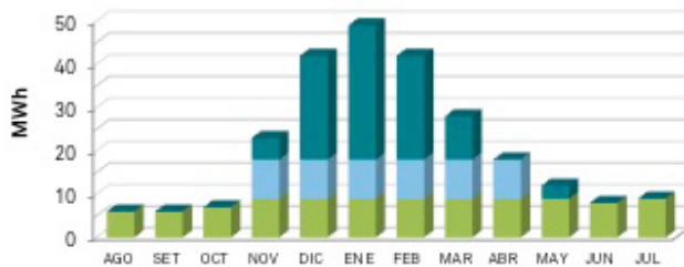
S'optimitza el funcionament de les màquines de Cogeneració perquè funcionen ininterrompudament 9 mesos/any
