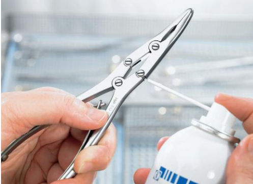
Lubricado de los tornillos de un instrumento articulado
