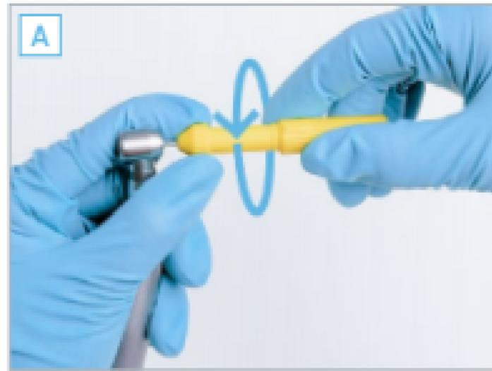
Usa el Lubrimed insertándolo directamente en el rotor de la turbina y haciéndolo girar en U
